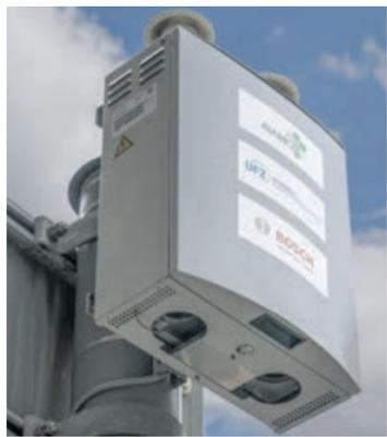
Eine Sensorbox für Luftqualitätsmessung ist an einer Infrastruktur des Mobilitäts- und Tiefbauamtes am Martin-Luther-Ring in Leipzig montiert. Foto: BS/Stadt Leipzig
